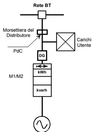
**Figura 17 - Schema di collegamento dei sistemi di misura presso un Utente attivo con cessione totale dell'energia elettrica prodotta, al netto dei servizi ausiliari**
