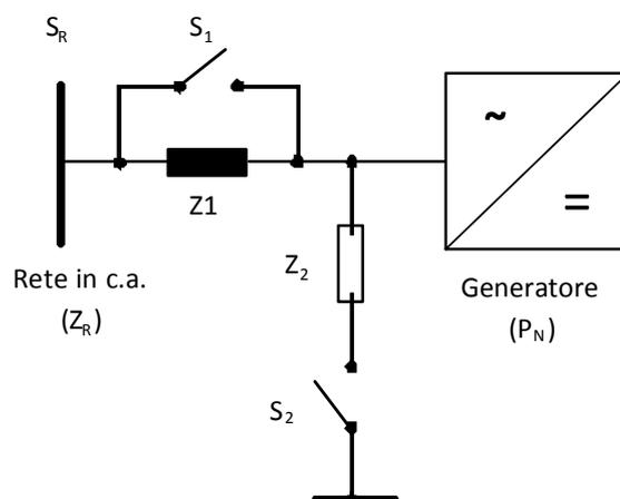
**Figura 32 - Esempio di circuito di prova per simulare gli abbassamenti temporanei di tensione**
