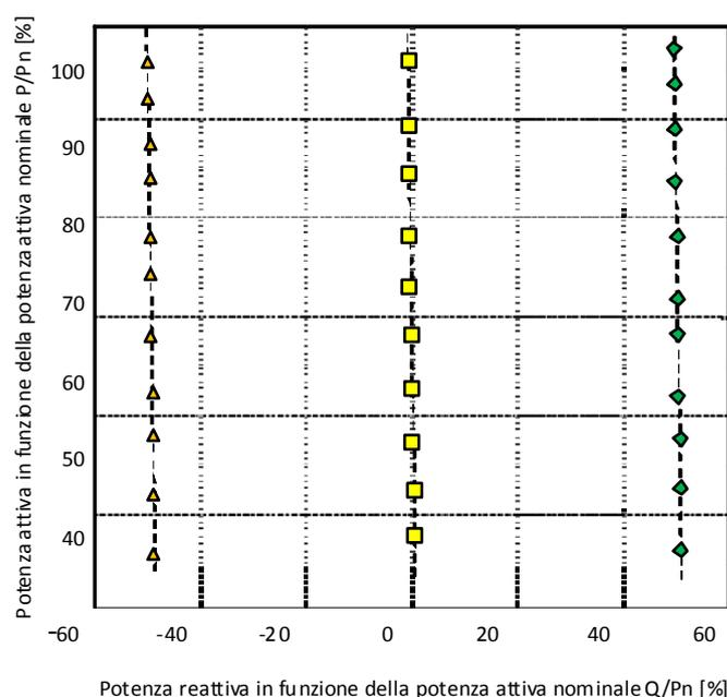
**Figura 23 - Esempio di Grafico  $P(Q)$ . Massima potenza reattiva induttiva e capacitiva erogata in funzione della potenza attiva (qui è rappresentato il caso di un inverter di potenza superiore a 6kW, che deve poter assorbire o erogare a qualsiasi livello di potenza attiva una potenza reattiva pari almeno al 48,43 % della potenza attiva nominale,  $Q_{min}/P_n = 48,43 \% P_n$ )**
