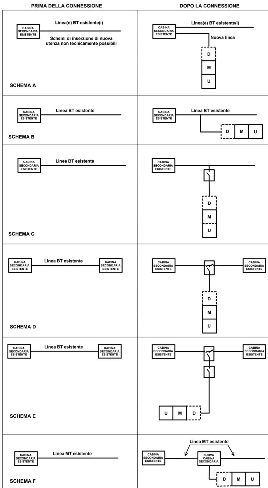
**Figura 2 – Schemi di inserimento dell’impianto di Utente**
