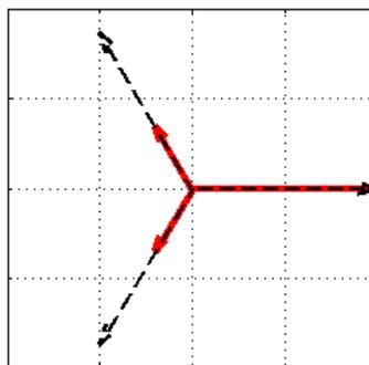
Queste alterazioni si propagano sulle linee di distribuzione in bassa tensione con valori di ampiezza delle singole tensioni ed angolo di fase che sono dipendenti dalle caratteristiche dei trasformatori presenti nella cabina di distribuzione, in particolare gruppo vettoriale ed impedenza.
