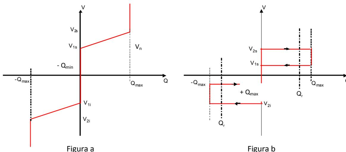
**Figura 39 - Curve caratteristiche standard  $Q=f(V)$ .<sup>64)</sup>**
