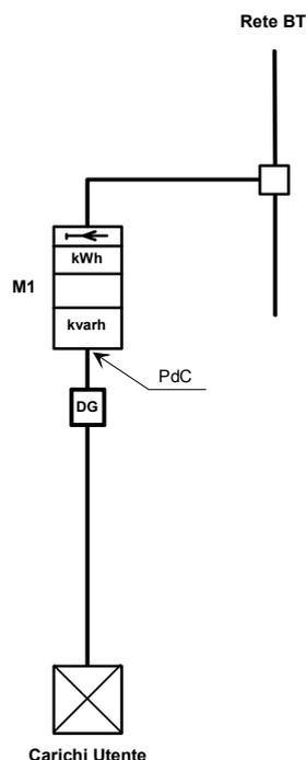
**Figura 16 - Schema di collegamento dei sistemi di misura presso un Utente passivo**
