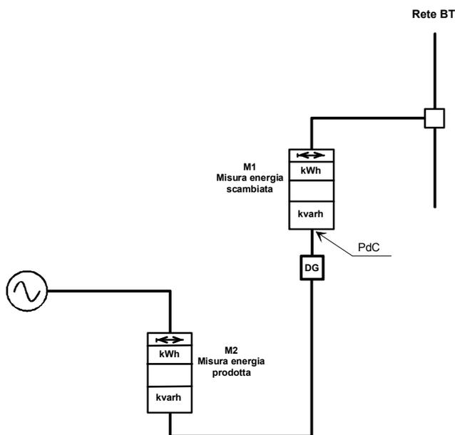
**Figura 19 - Schema di collegamento dei sistemi di misura presso un Utente attivo con immissione totale dell'energia elettrica prodotta e con misura dell'energia**
