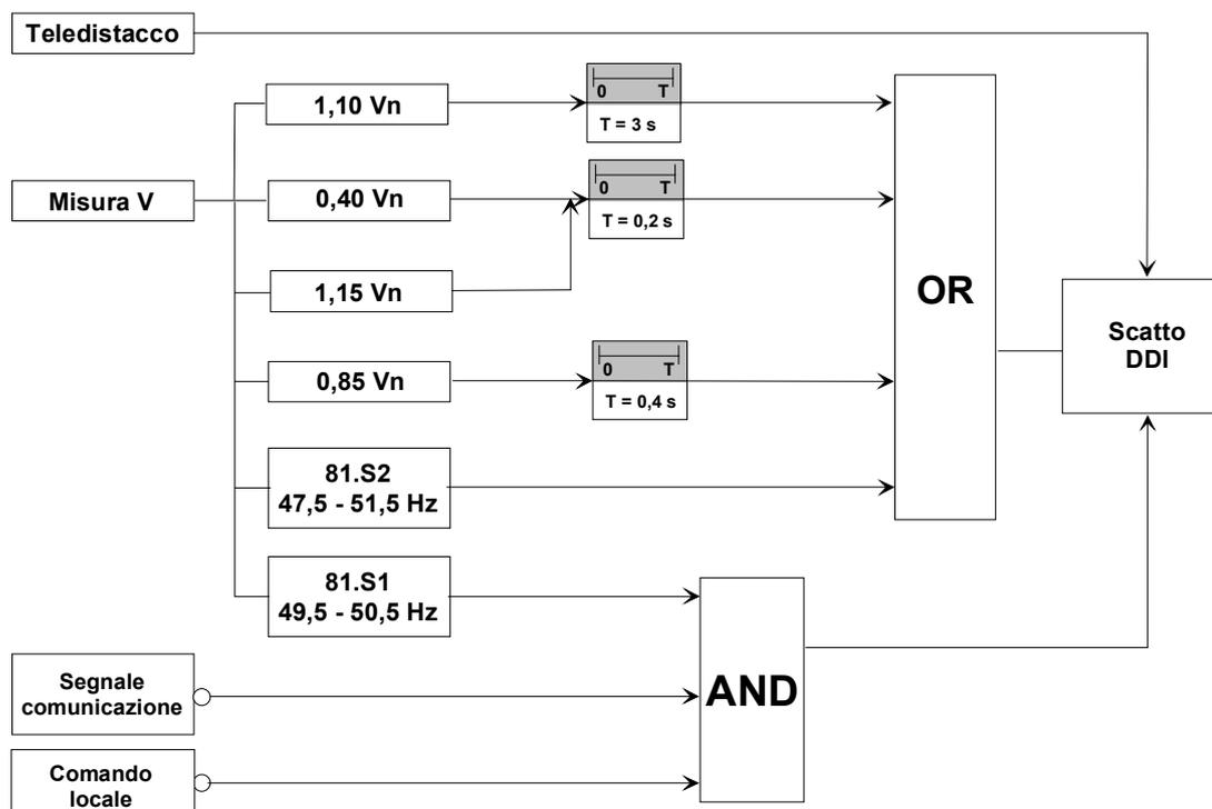
Figura 15 - Schema logico funzionale del SPI
