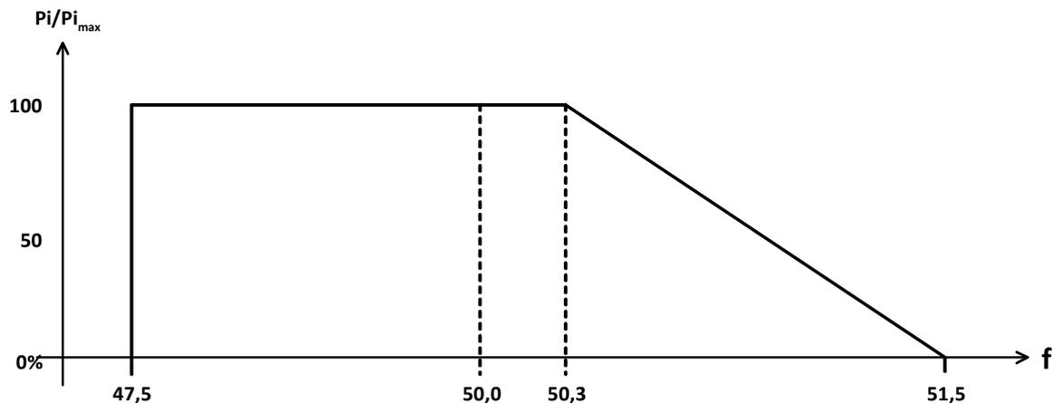
Figura 40 – Curva di riduzione della potenza attiva in sovralfrequenza
