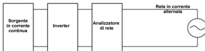
NOTA Questo circuito di prova si applica ai sistemi monofase. Per sistemi trifase si dovrà prevedere un circuito equivalente di tipo trifase.
