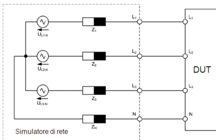
**Figura 34 - Utilizzo di simulatore di rete**
