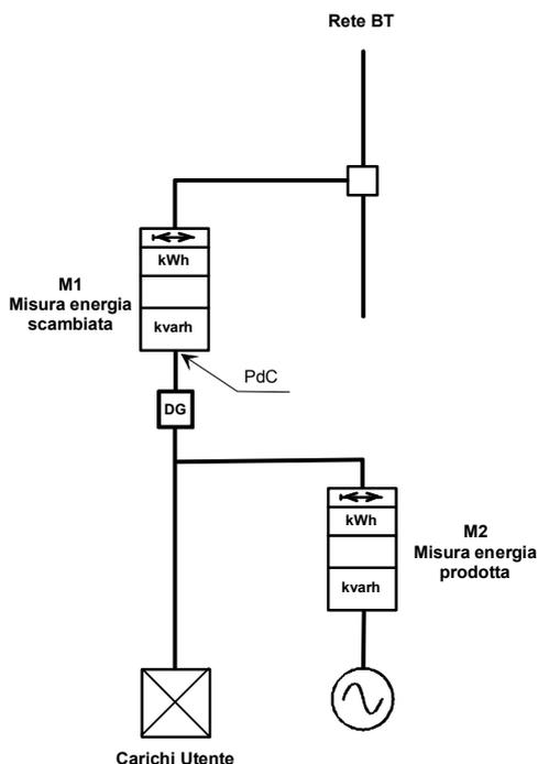
**Figura 18 - Schema di collegamento dei sistemi di misura presso un Utente attivo con immissione parziale dell'energia elettrica prodotta**
