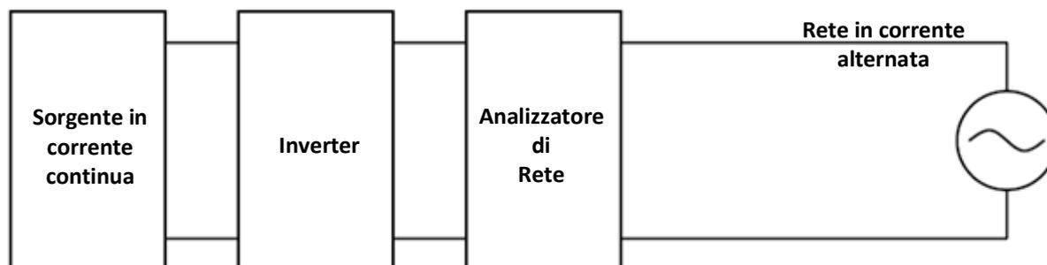
NOTA Il circuito di prova illustrato è relativo a sistemi monofase; per sistemi trifase si dovrà prevedere un circuito equivalente di tipo trifase.
