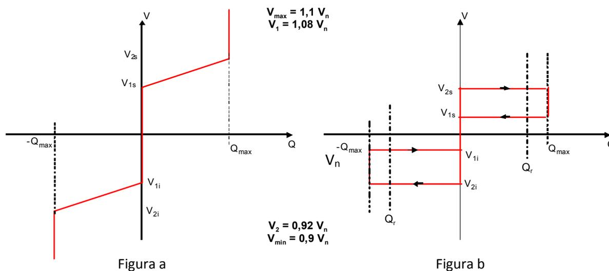
Figura 28 - Curve caratteristiche standard  $Q = f(V)$
