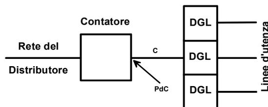
**E' possibile l'installazione fino a 3 dispositivi Generali di Linea (DGL), ciascuno a protezione di una singola linea d'utenza, in alternativa al DG**
