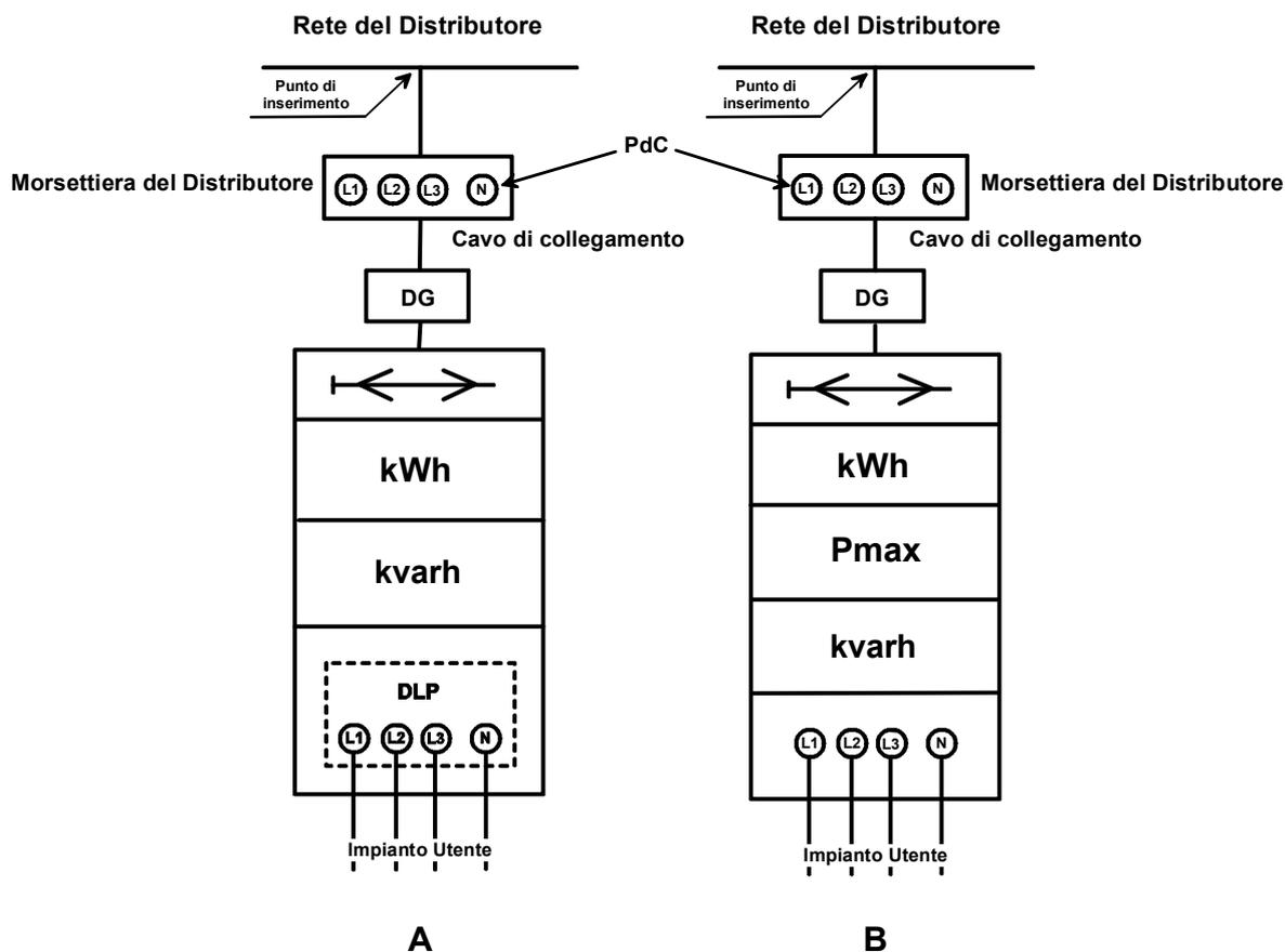
**Figura 4 – Schema di collegamento di utenze con immissione totale dell'energia e misura diretta**
